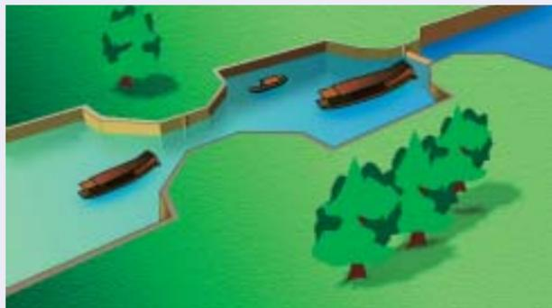
■図4—上下流2つの水門を交互に閉じて水量調整し、河船をさかのぼらせた通惠河の閘門(イメージ図)
