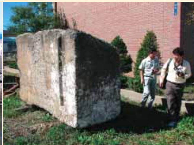
写真4—引き上げられた捨塊ブロック
