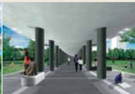
■図6—RCスラブ式CFT柱ラーメン高架橋(CG)
