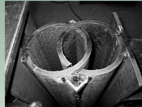
写真2 縞鋼管継ぎ手(載荷試験供試体)
