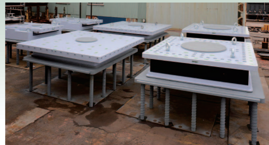
写真3 支承受組状況(左:端橋脚可動柵、中:中間橋脚鉛直柵、右:中間橋脚水平柵)
