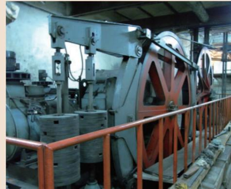
写真12 管理室にあるケーブルのブレーキ装置
