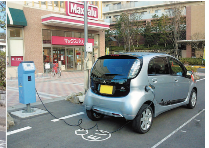
写真3 EV給電スタンド
