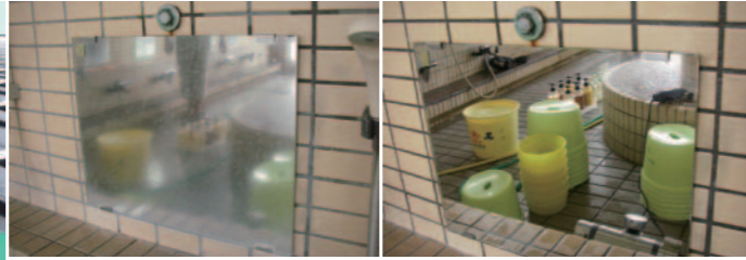
写真8 シラスバルーンを配合したクリーナーの洗浄効果(左:洗浄前 右:洗浄後)
