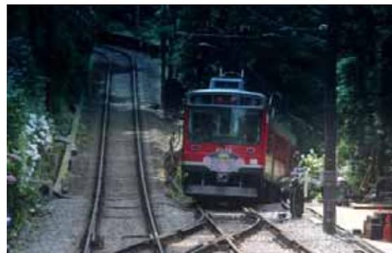
スイッチバックで車両の進行方向が逆向きになるため、運転士と車掌が入れ替わる必要があるが急勾配を登るためには必要な工夫である。スイッチバック方式を用いている鉄道は日本では数少ない。
