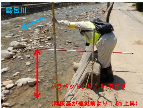
写真-5.2.7 河道内の土砂堆積（野呂川）
