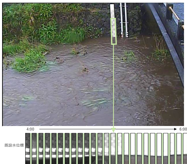
図-7 既設水位標の水位判読手法
