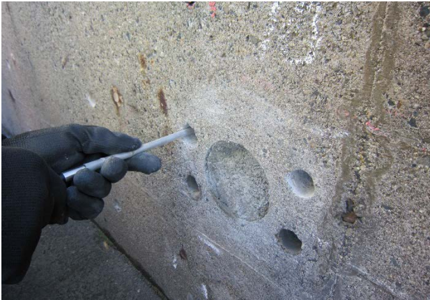
図-7 吸光度スペクトルの測定状況
