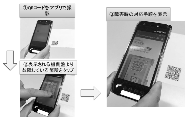
写真-2 ARを用いた操作支援機能
