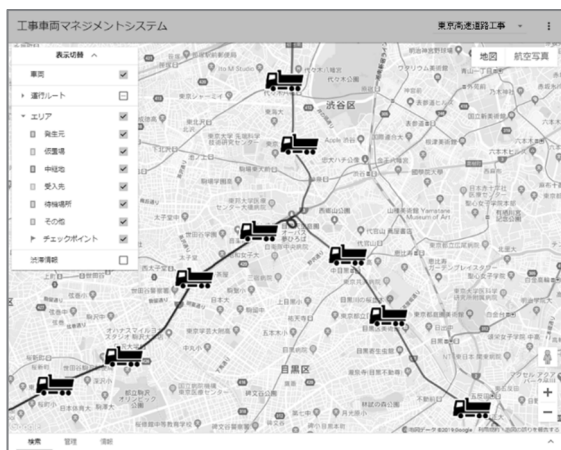
図-2 各運搬車両のリアルタイム位置表示
