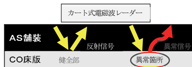
図-4 カート式電磁波レーダー調査イメージ図
