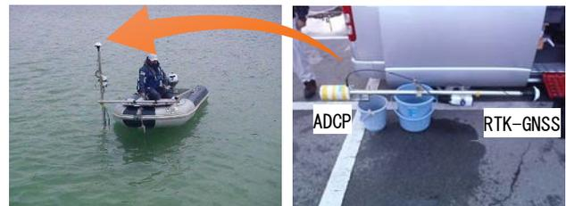
図-5 RTK-GNSSとADCPを搭載したゴムボート
