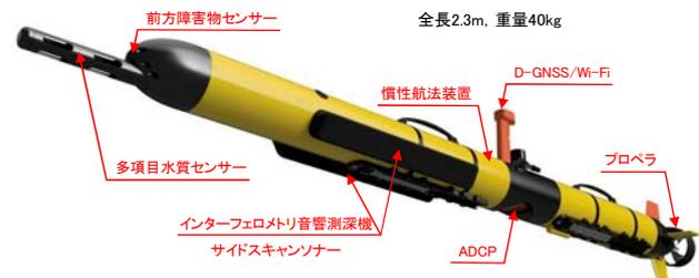
図-1 貯水池の堆砂状況調査に導入したAUV
