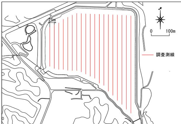
図-3 香川用水調整池内に設定した調査測線
