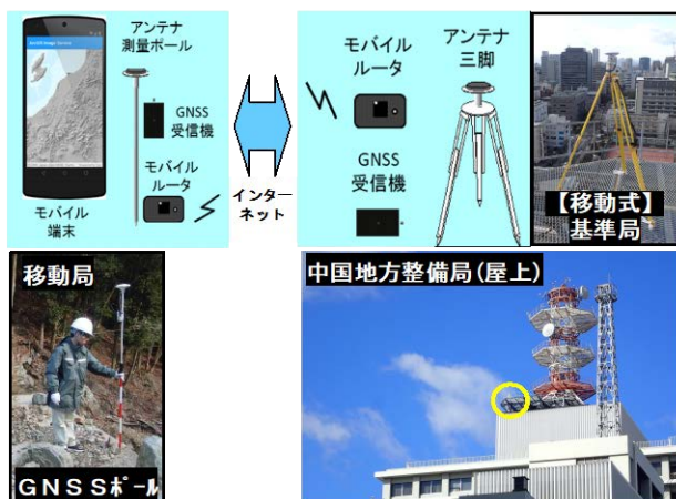
図-4 高精度衛星測位（RTK測位）の機器構成
