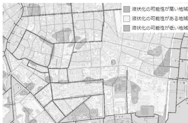
図-1 東京都の液状化予測図平成24年度改訂版より
