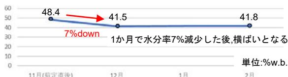
図-6 剪定枝水分率(加熱乾燥式水分計にて計測)
