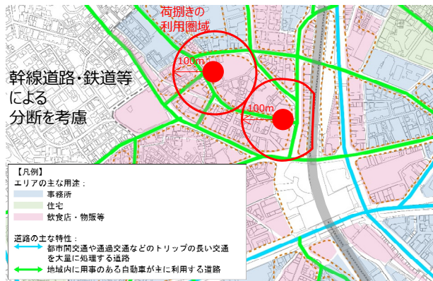
図-8 荷さばき車用集約駐車場の配置イメージ 出典3
