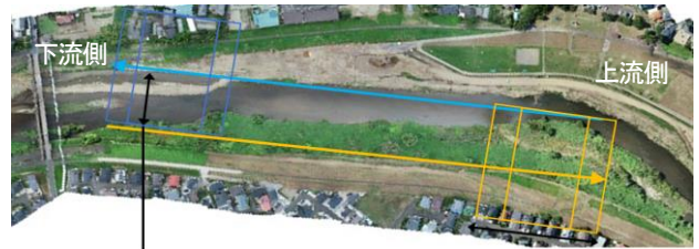
サイドラップ率：60% オーバーラップ率：80% →：飛行ルート(右岸より) ←：飛行ルート(左岸より) ※川幅によって本数の変更あり 流軸に沿って撮影
