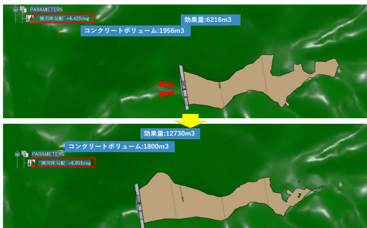
図-5 堰堤位置変更に伴う効果量及びCoボリューム自動計算
