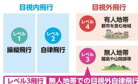
図-1 UAVの飛行レベル
