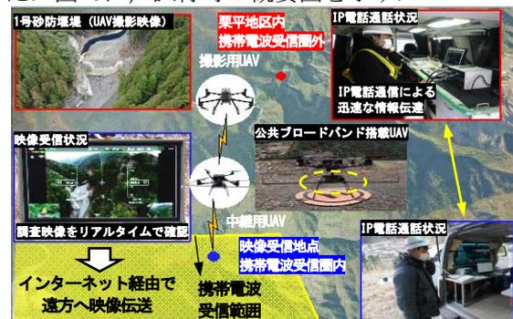
図-8 公共BB搭載UAVによる映像情報の自動伝送
