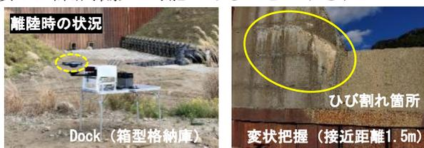
図-9 全自動飛行による砂防施設の点検の例
