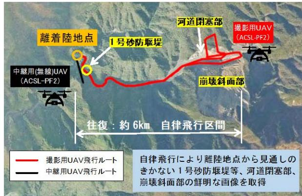
図-4 2機体同時飛行による飛行ルート
