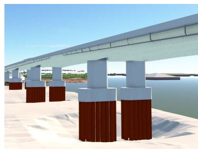
図-3 局所洗掘の状況（BIM/CIM）
