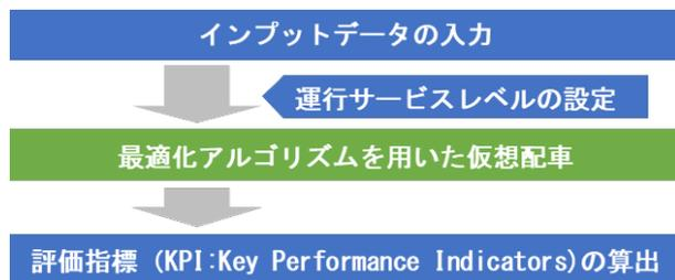
図-2 シミュレーションの実施フロー
