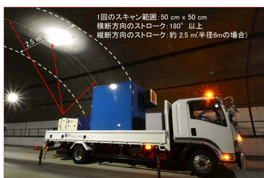
写真-2 レーザー打音検査装置による計測範囲
