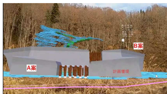
図-7 投影させた堰堤のイメージ(MRデバイス)
