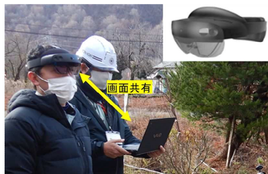
図-1 MRデバイス (HoloLens2) 装着のイメージ
