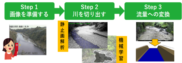
図-1 静止画像による新しい流量観測手法の概念図
