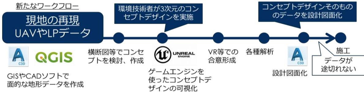
図-2 ゲームエンジンを用いたかわづくりのワークフロー
