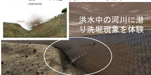
図-14 洪水の中で見た洗堀進行の様子
