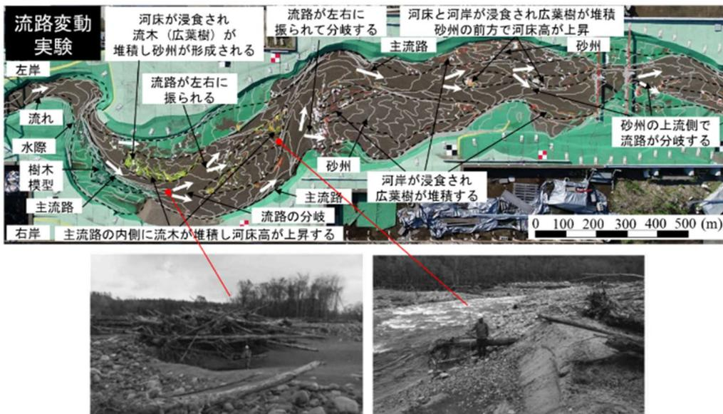
図-7 流路の変動・分岐実験と現地踏査<sup>9)</sup>の比較
