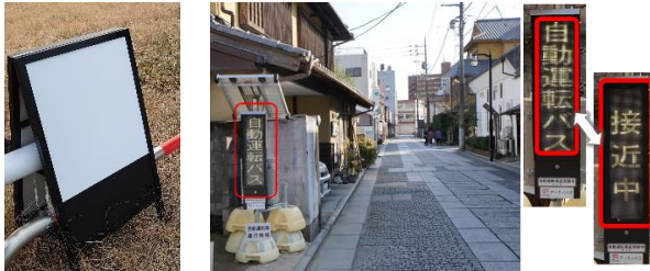
図-3 走行課題への対策(左図：自己位置推定の目印となる看板、右図：運行周知のための電光掲示板)
