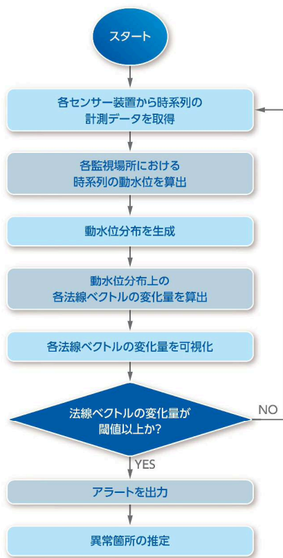
図 1 漏水検知フロー図
