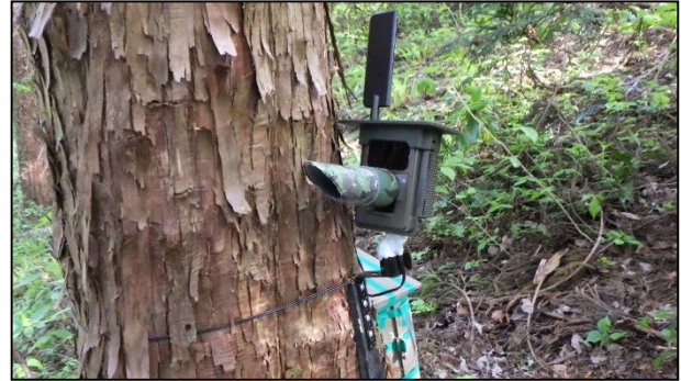
写真-1 遠隔監視カメラ
