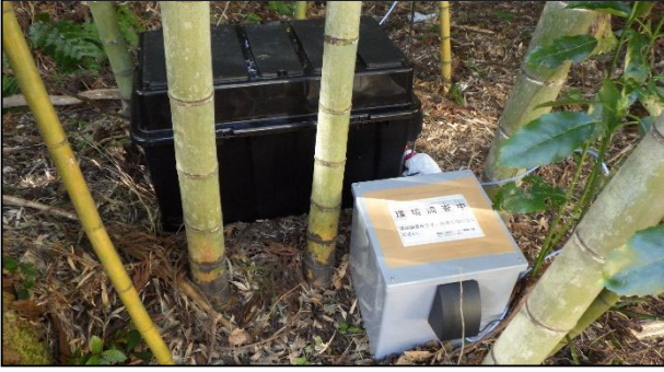
写真-4 AI技術による鳴き声解析システムを内蔵した観察装置
