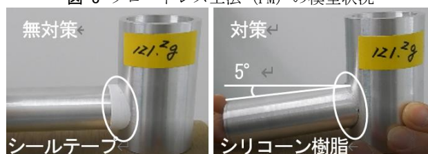
図-9 管更生工法(LM)の模型状況
