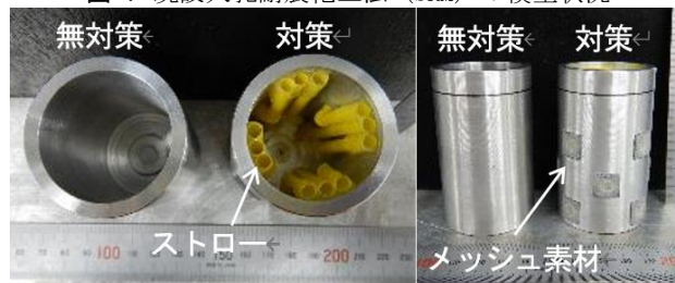
図-8 フロートレス工法(FM)の模型状況
