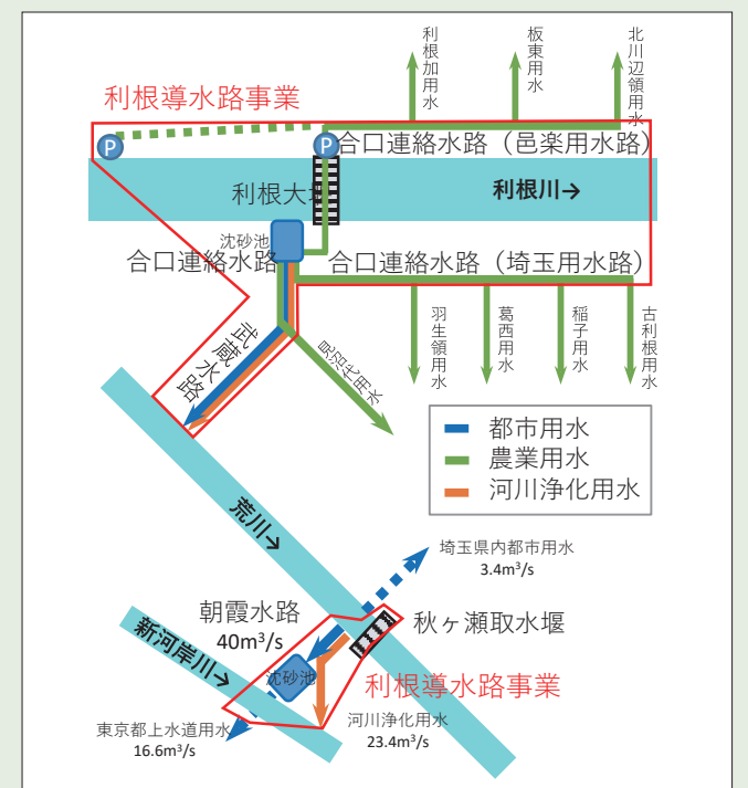
図3 S43管理開始当初の利根導水路用水系統模式図
