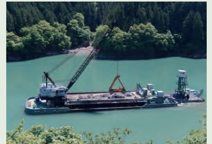
写真10 浚渫船の一例（ガッドバージ船）
