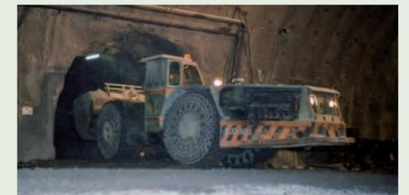
写真5 冷房付きのロードホールダンプ
