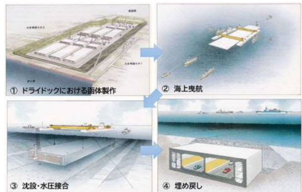
図-9 沈埋トンネルの施工手順
