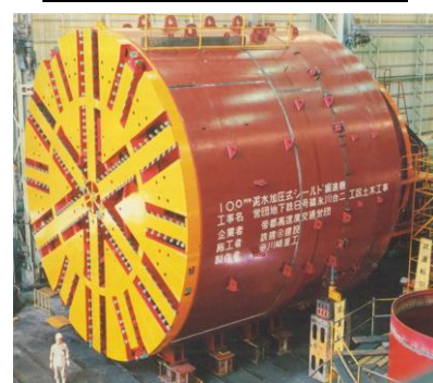
写真 3-4 泥水式複線シールド
