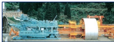
写真 14 トンネルワークステーション
