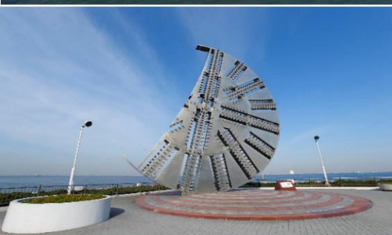
シールドマシン カッターフェイス (実物大)
