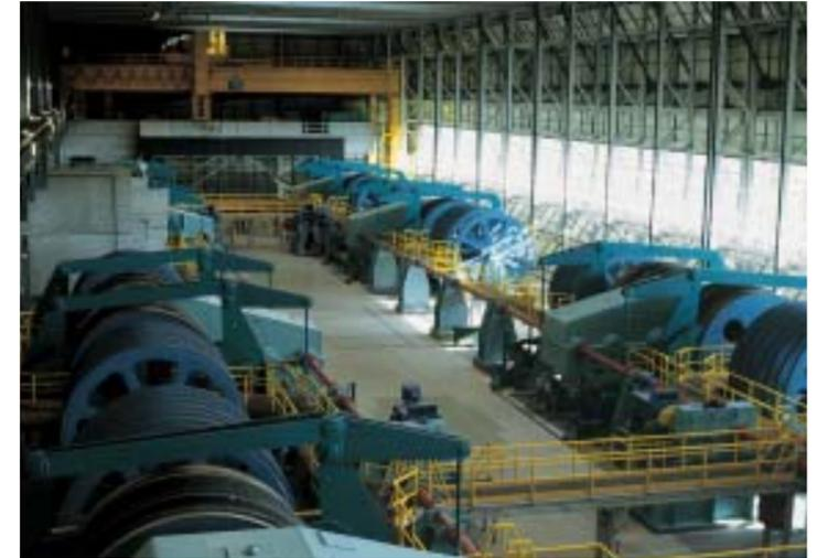
写真2 - 112本のワイヤーロープを巻き上げる巻き上げ機
