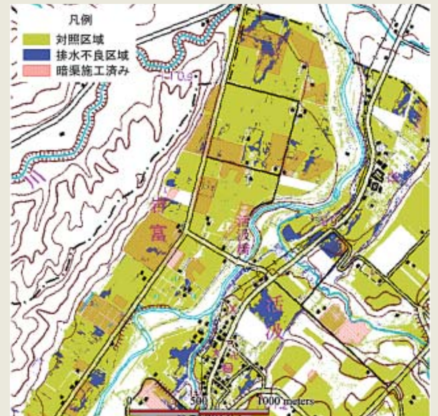
図8 - 排水不良区分図と暗渠排水施工位置の重ね図
