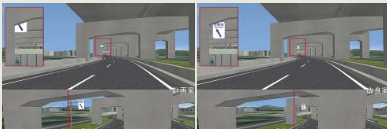
■図8—標識の配置検討(視認性をドライバー視点で橋脚との位置関係を検討)
