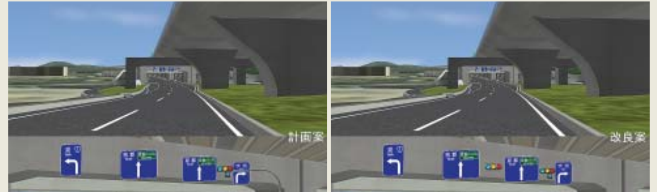
■図9—信号機の配置検討(視認性を考慮し、取り付け方法を変更)
