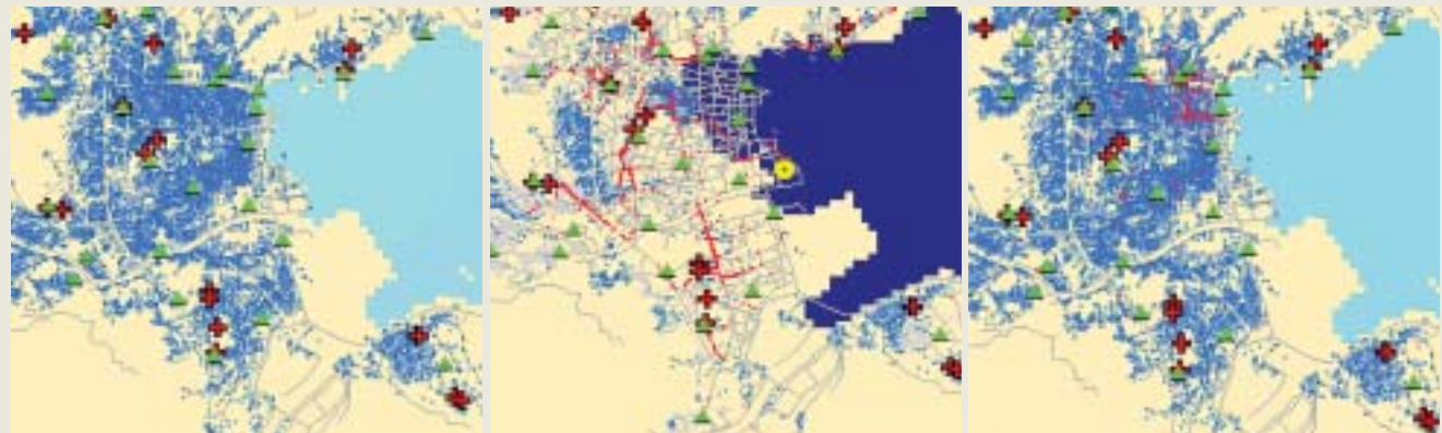
■図8—避難シミュレータの適用事例(片田研究室より提供) ラジオ、テレビあるいは行政無線拡声器(緑:三角)等からの情報を取得し、避難者(赤:小丸)が避難所(赤:十字)へ移動する状況をアニメーション表示し、津波の浸水状況を重ね表示する
