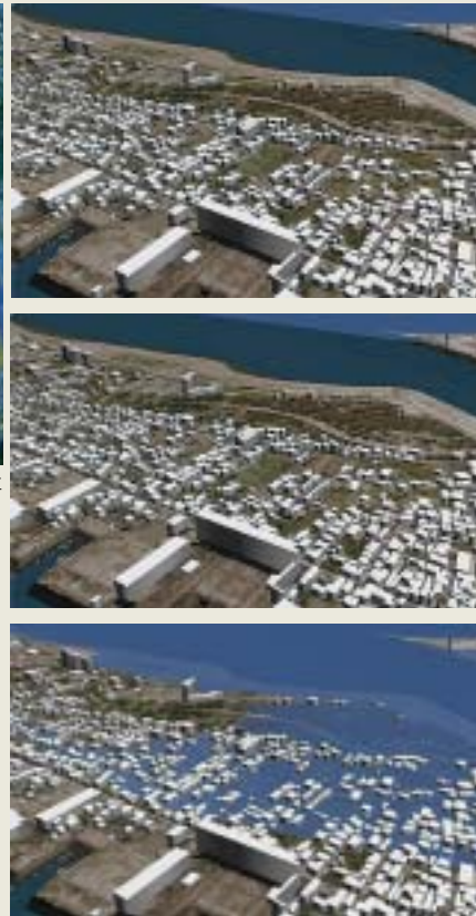
■図6—津波による浸水状況の3次元表現
