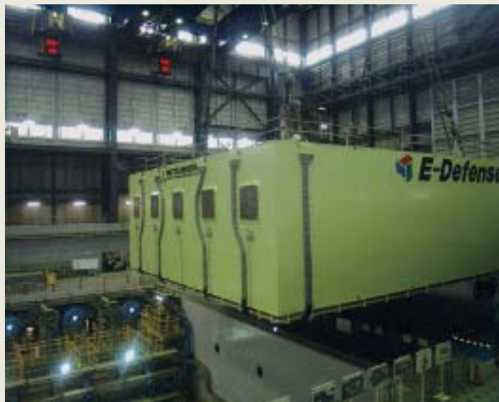
■写真4—振動台の設置
