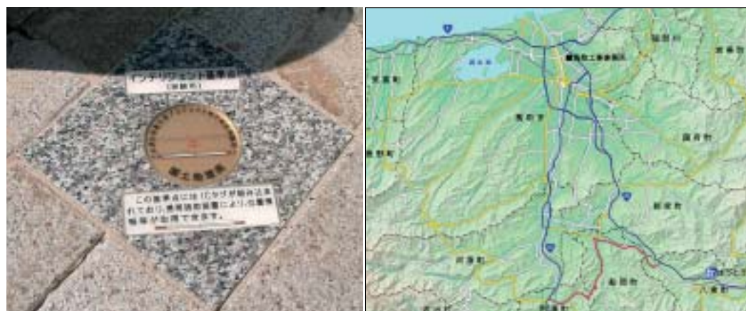
■写真1—基準点に付けられたICタグ 写真提供：国土地理院近畿地方測量部 ■図5—標高と道路データを用いて作成した管内図
