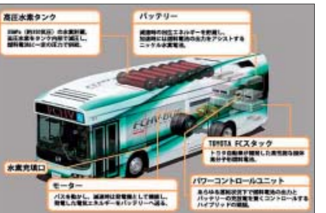
■図10—燃料電池バスの構造
