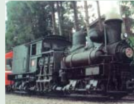
■写真5—山地部を走る主力の3シリンダー28tシェイ式蒸気機関車
