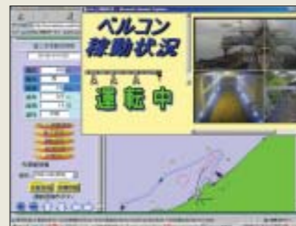
■図12—運行管理・工事情報システム(Webサイト)下側に土運船の運行管理画面が、上側にベルトコンベアの稼働状況(動画)が表示されている
